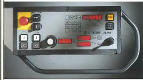
Drei Achsen in Augenhöhe unter Kontrolle. Hier mit Sonderausstattungen VARIO-Antrieb und Vorritzer.
